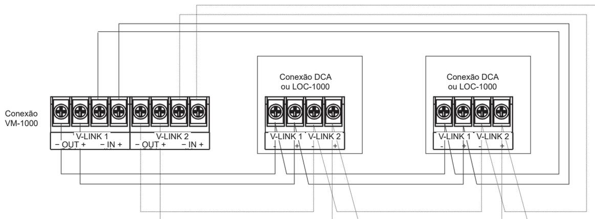
Figura 48. Exemplo de conexão do VM-1000 V-Link 1 e 2 Classe A
