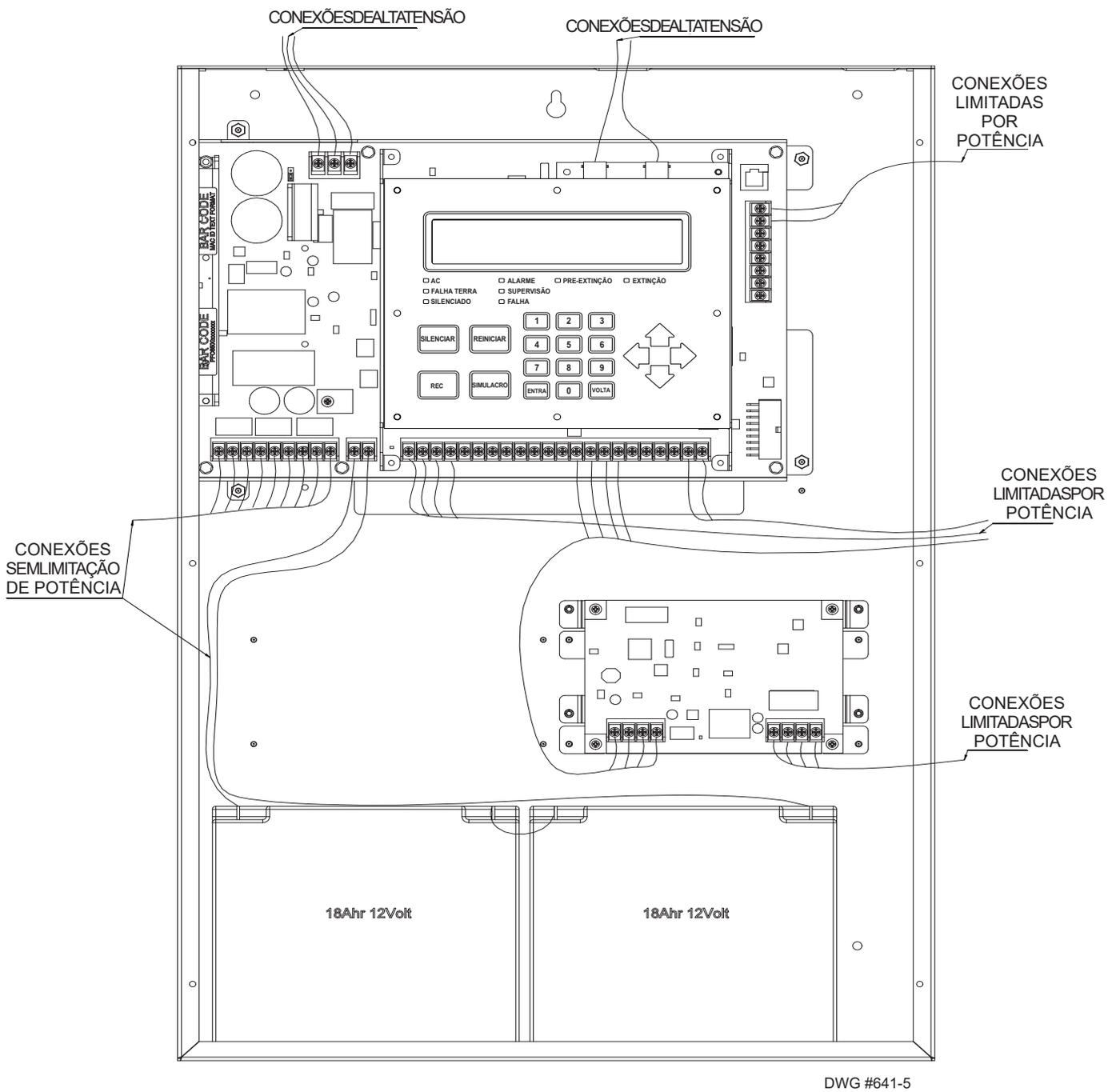
Figura 20. Exemplo do Roteamento de Fios do Painel
