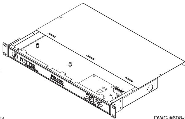
Figura 32. Ponte FIB-1000 e FIB-1000RM Mostrando Montagem em Rack
