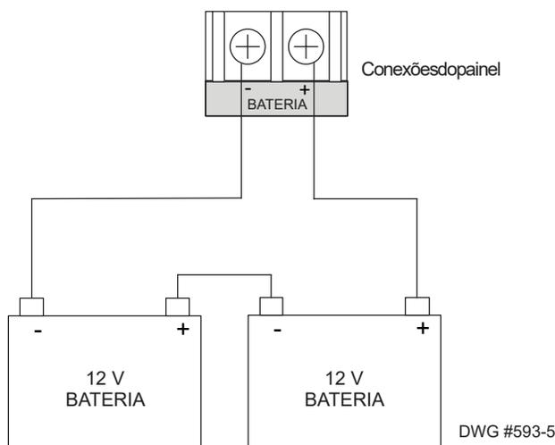
Figura 3. Conexões do Circuito da Bateria
