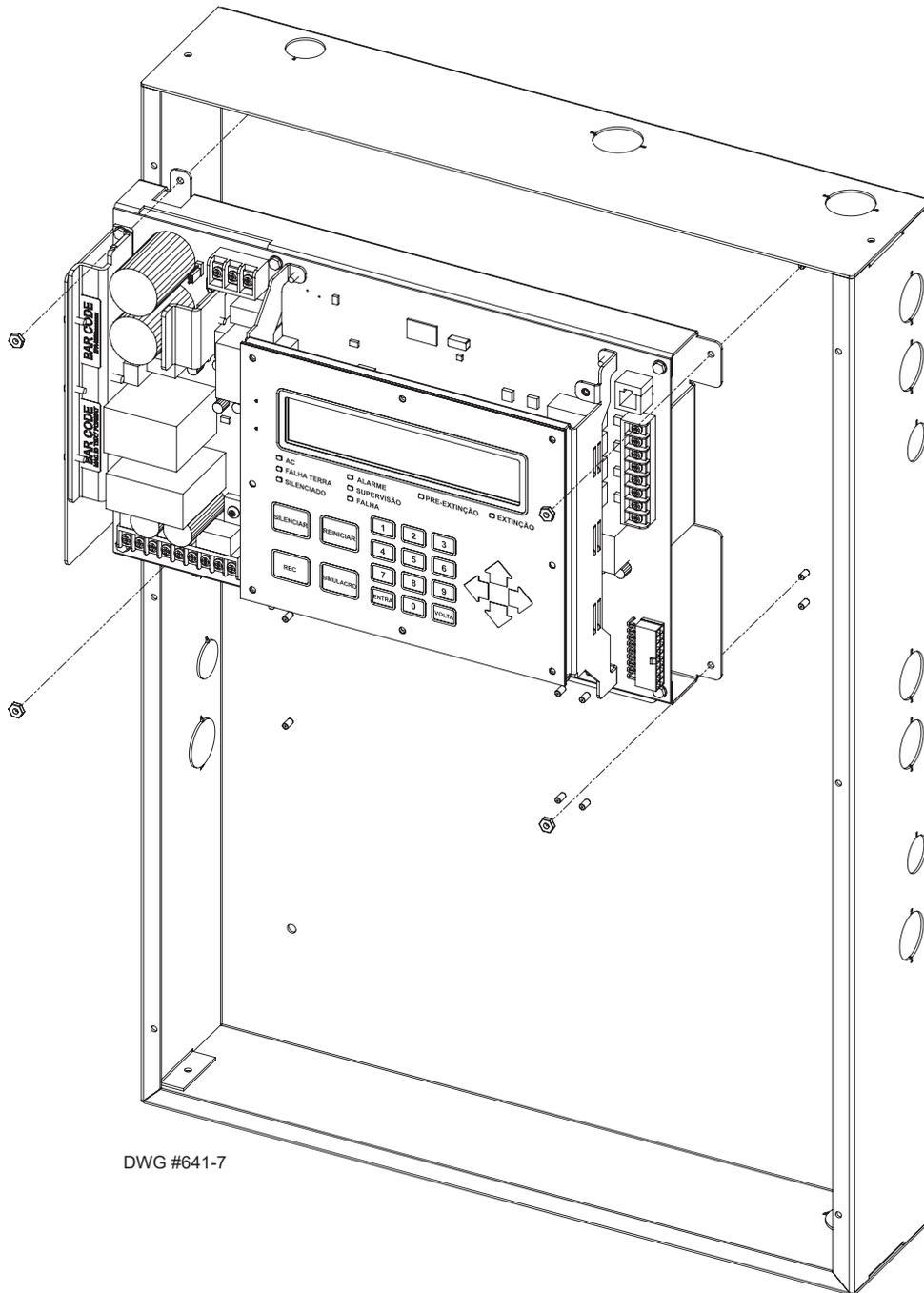
Figura 40. Gabinete do AFC-1000 Mostrando Conjunto da Placa Eletrônica
