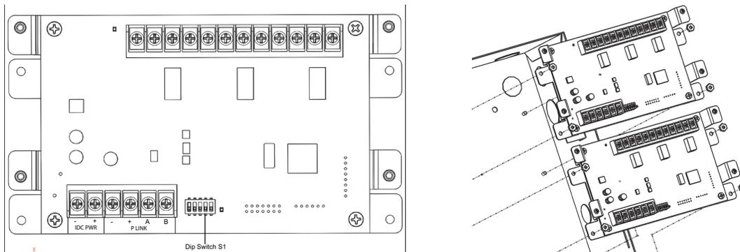
Figura 35. Expansor do Circuito de Dispositivo Iniciador IDC-6 e sua Instalação
