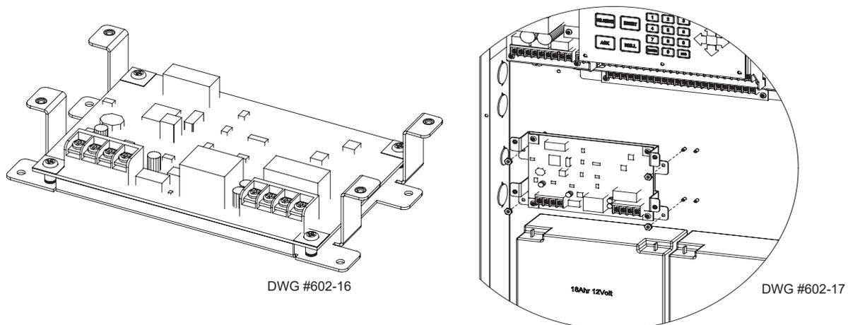
Figura 22. PAD100-SLCE / Placa SLCE-127 para Protocolo Nohmi Instaladas no Gabinete AFC-1000
