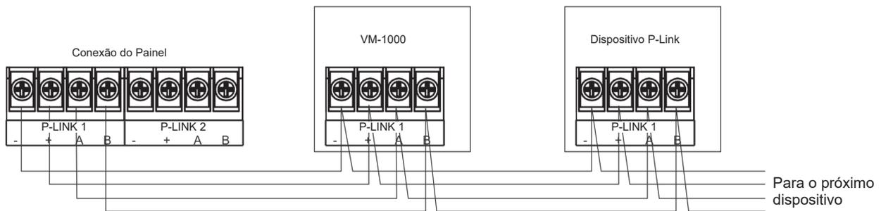
Figura 43. Exemplo de conexão do VM-1000 P-Link Classe B
