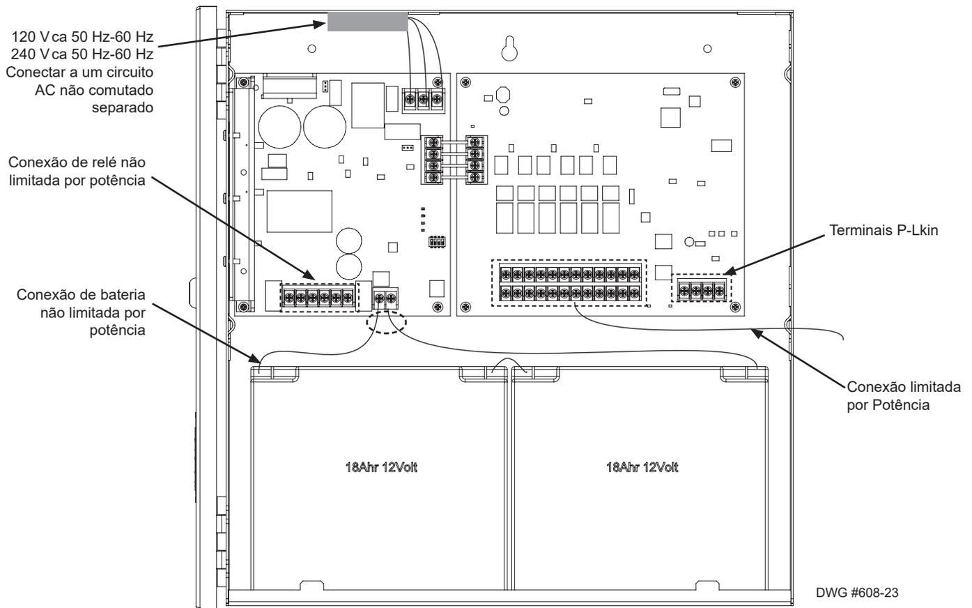
Figura 21. Exemplo de conexão do PSN-1000
