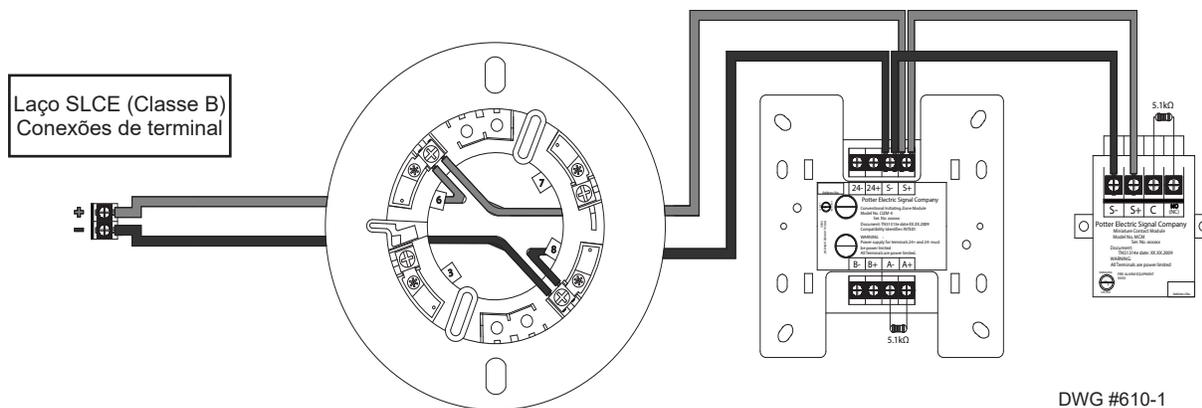
Figura 13. Exemplo de SLC de Protocolo Nohmi como Classe B
