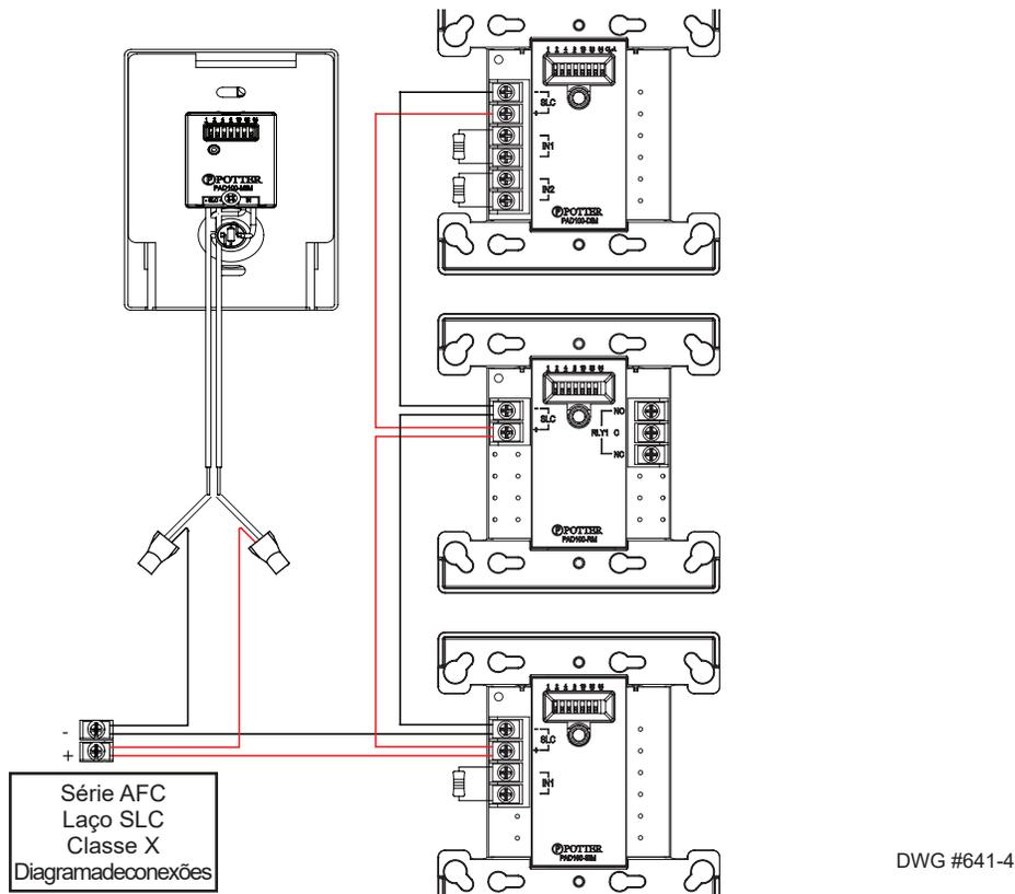
Figura 10. Exemplo de SLC de Protocolo PAD como Classe B
