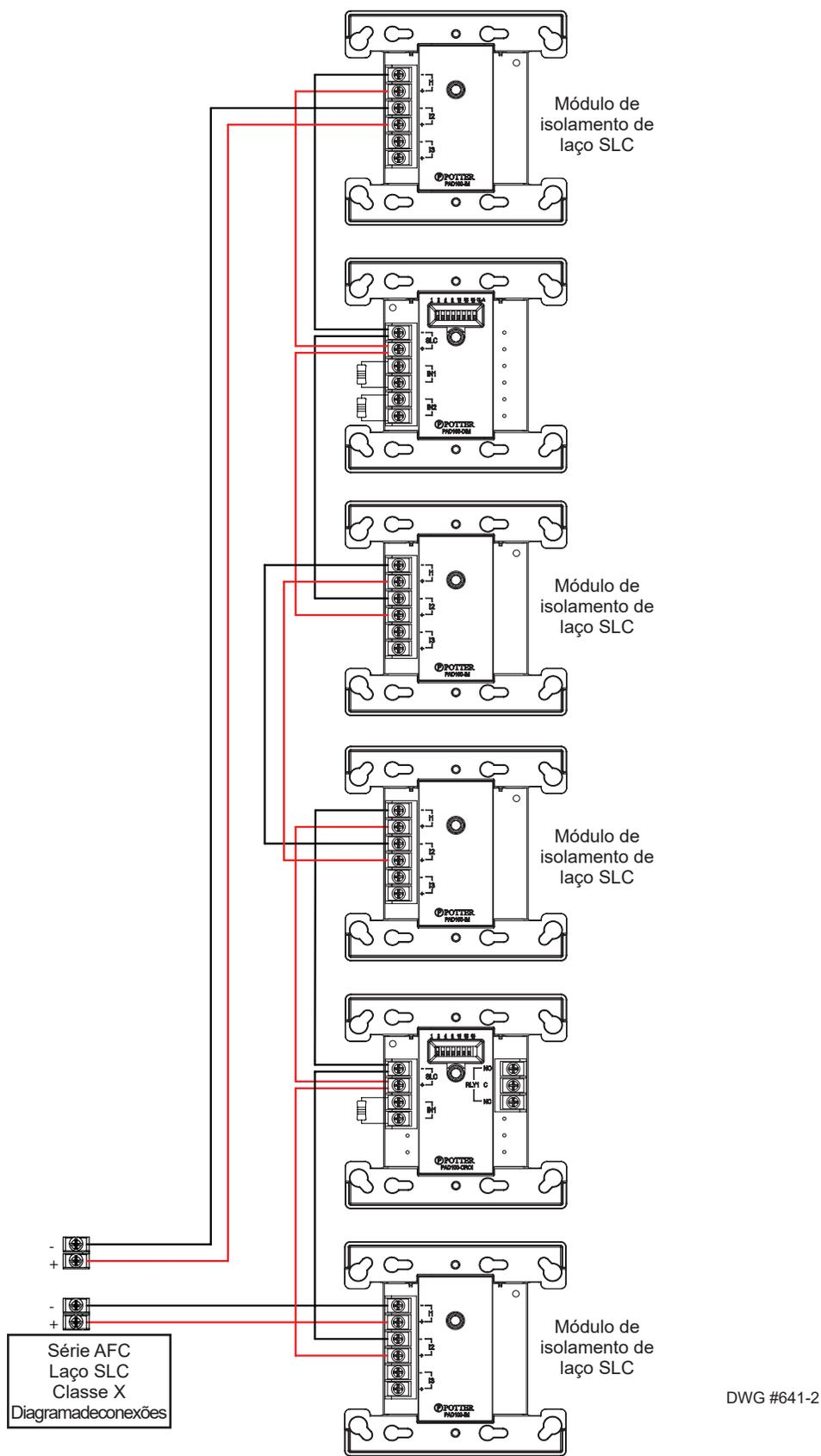
Figura 8. Protocolo PAD Classe X mostrando PADI00-IMs instalados
