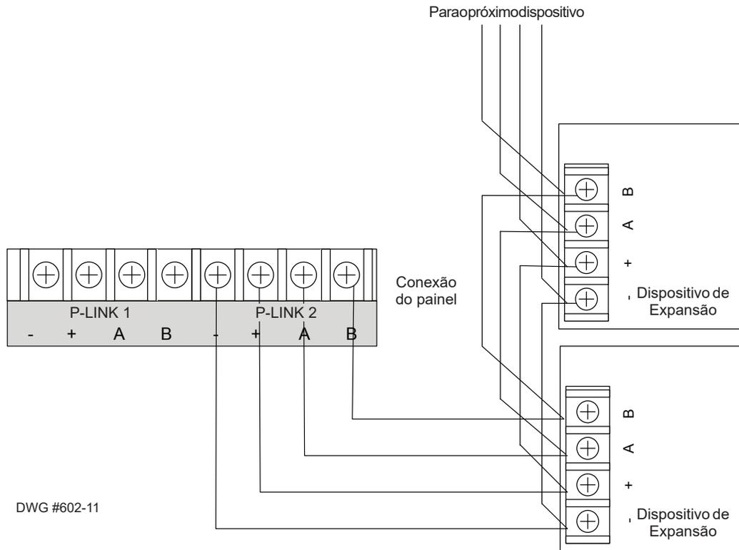
Figura 14. Exemplo de conexão do P-Link Classe B
