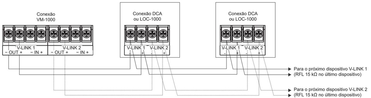
Figura 47. Exemplo de conexão do VM-1000 V-Link 1 e 2 Classe B
