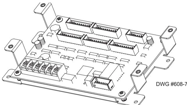
Figura 25. Placa do DRV-50 Mostrando o Suporte de Montagem
