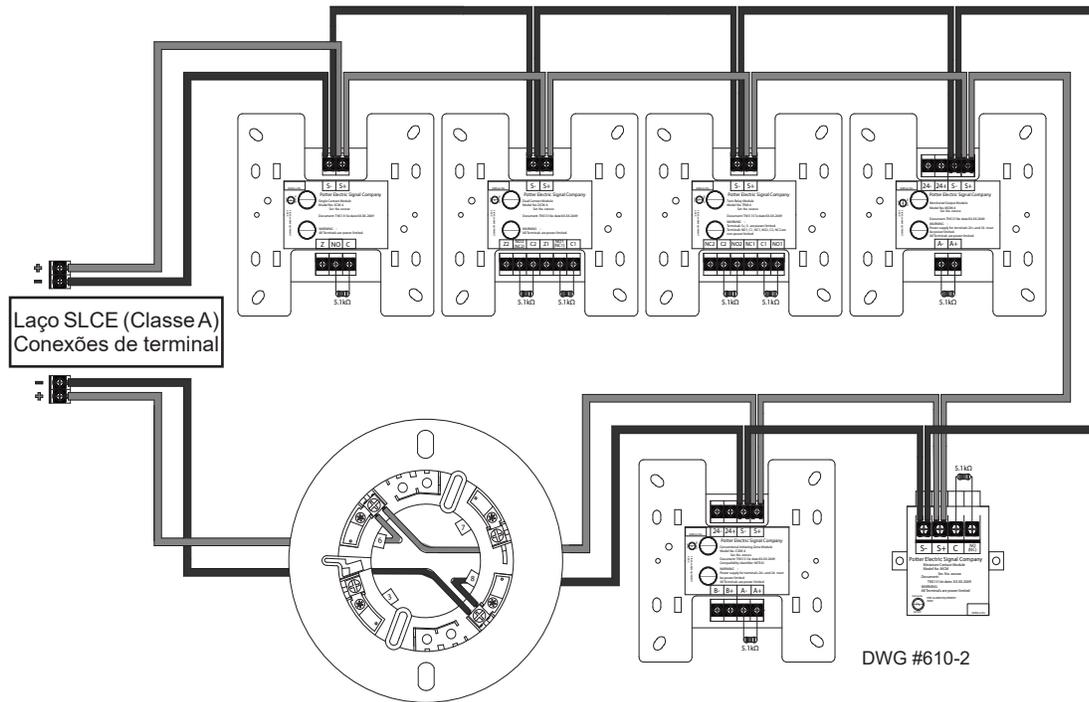
Figura 12. Exemplo de SLC Classe A Cabeado no Protocolo Nohmi
