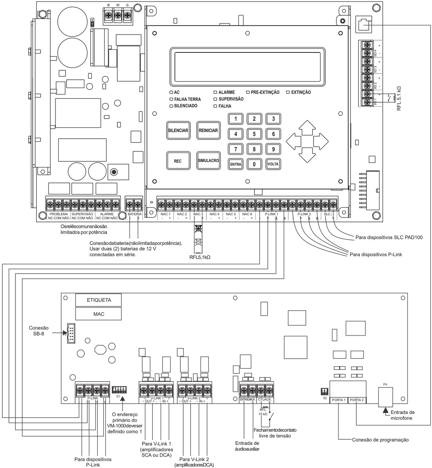
Figura 41. Diagrama de Conexão do Painel de Incêndio Endereçável com Voz Integrada AFC-1000V
