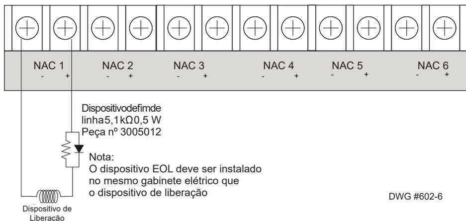
Figura 16. Conexão do circuito de liberação NAC com Conjunto EOLD
