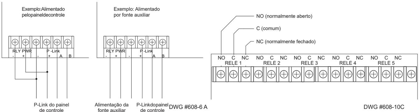
Figura 30. Conexão do RLY-5 para o Painel de Controle / Fonte de Alimentação Auxiliar e Contatos Normalmente Abertos / Normalmente Fechados do RLY-5
