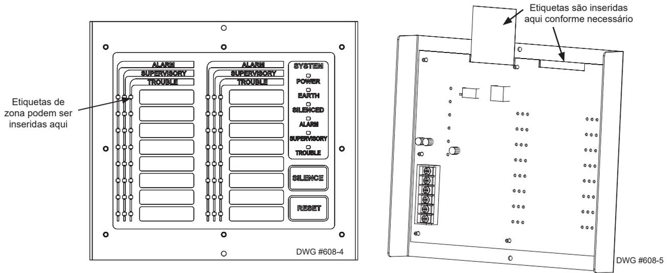
Figura 23. Módulo e Placa LED-16/LED-16(F)
