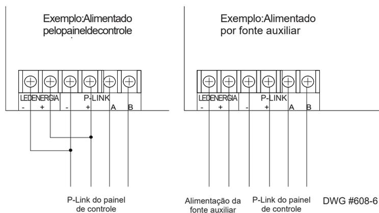
Figura 28. Exemplos de conexão de um DRV-50 do Painel de Controle ou Fonte Auxiliar
