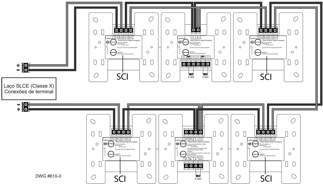
Figura 11. Exemplo de SLC Classe X Cabeado no Protocolo Nohmi
