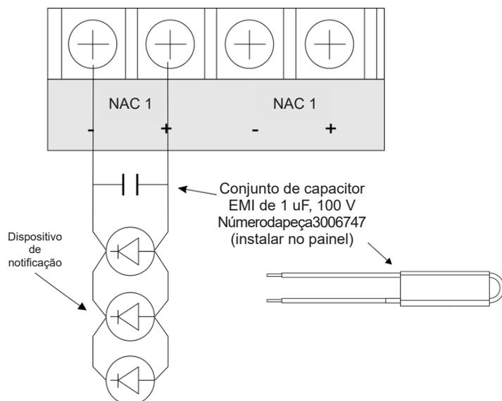
Figura 6. Diagrama de conexão do conjunto de capacitores NAC EMI
