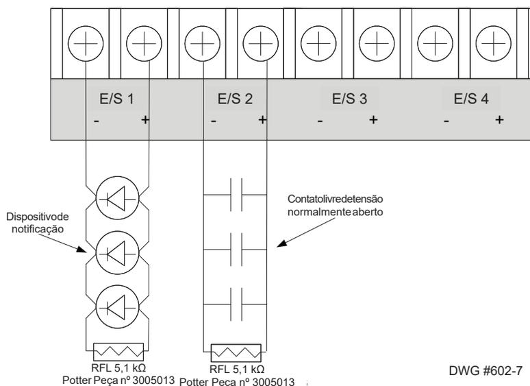
Figura 7. Circuitos de E/S Mostrados como NAC Classe B / Entrada com contatos livres de tensão
