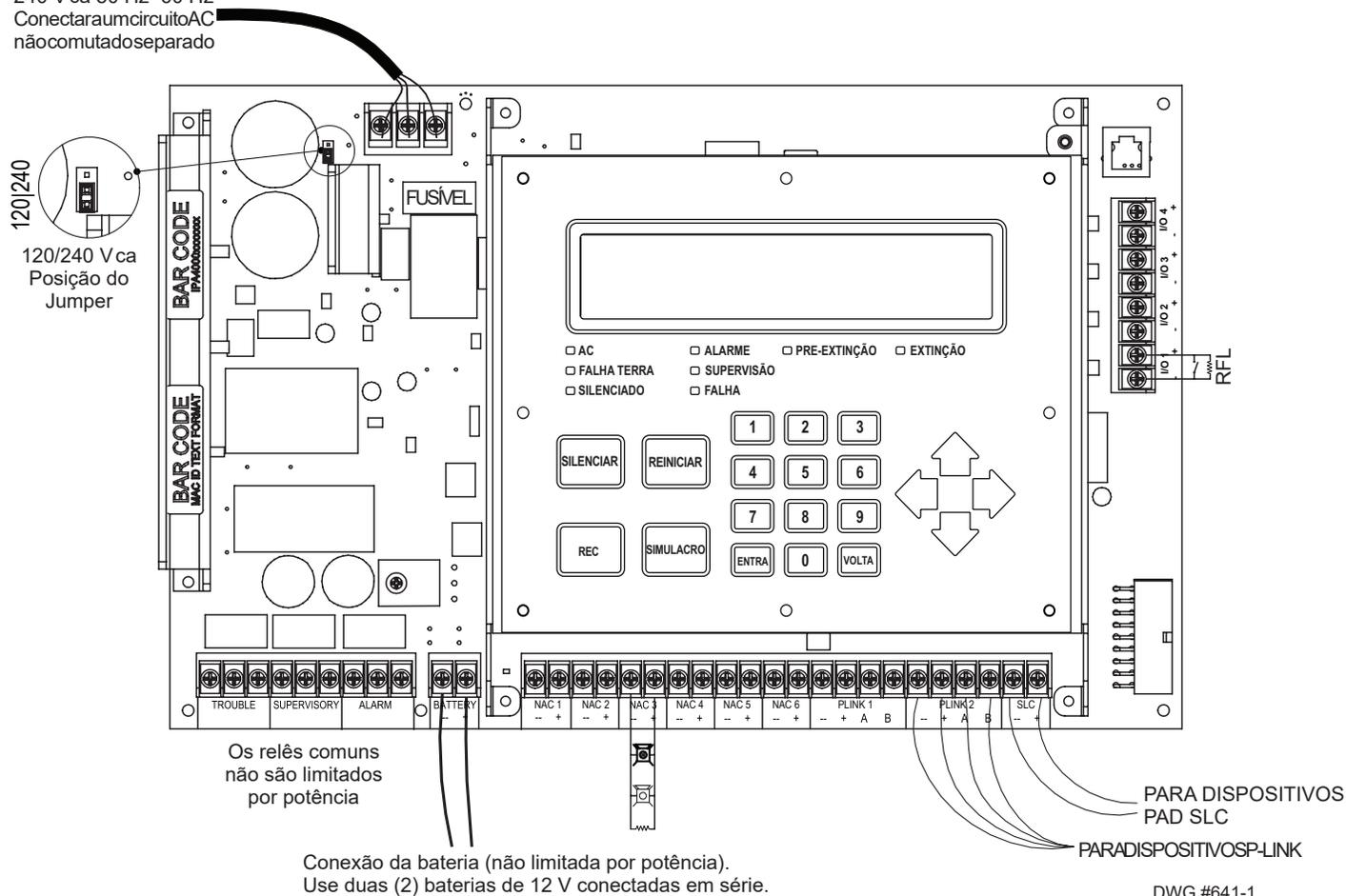
Figura 1. Diagrama de conexão do Painel de Incêndio Endereçável AFC-1000
