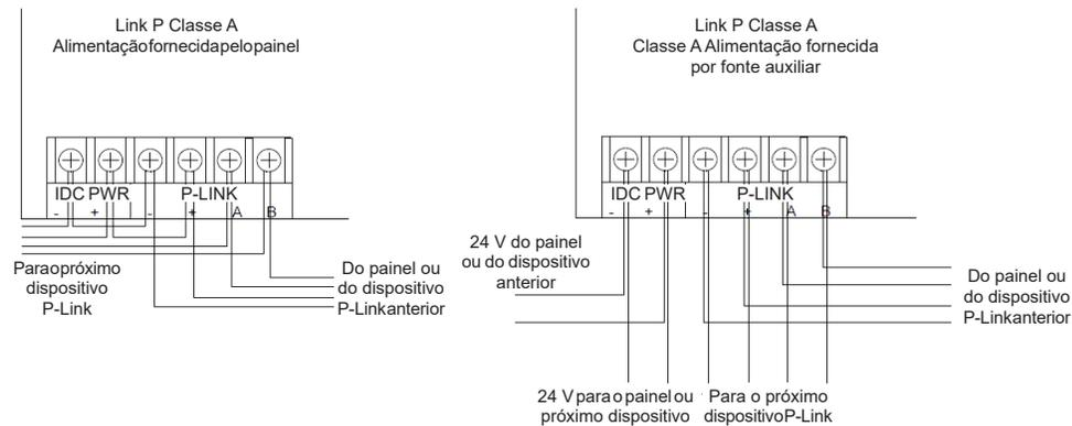
Figura 36. Conexão IDC-6 Classe A
