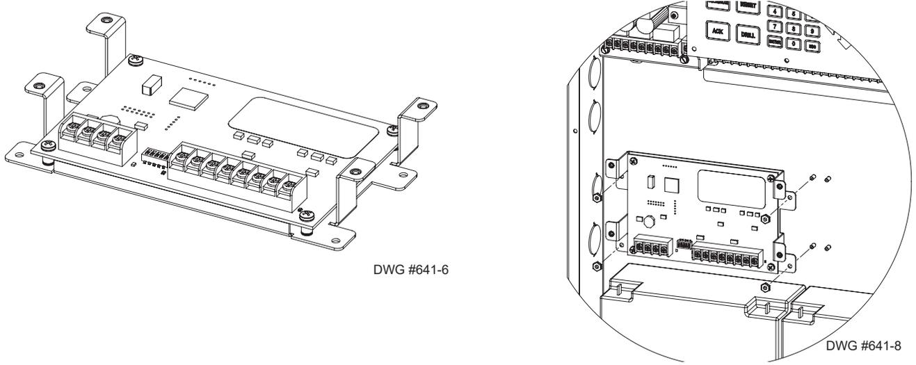
Figura 34. Placa de Multiconexões MC-1000 e MC-1000 Instalada no Gabinete AFC-1000
