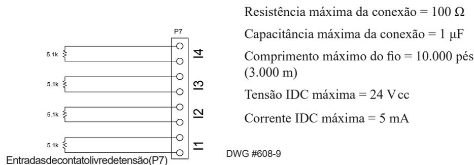
Figura 27. Conector de Entrada "P7" com contato livre de tensão DRV-50
