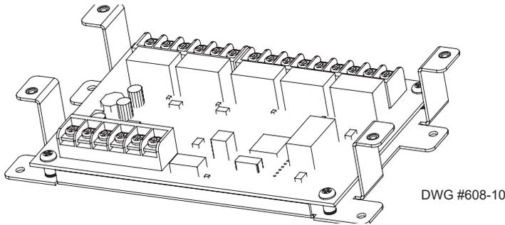
Figura 29. Placa do RLY-5 Mostrando o Suporte de Montagem
