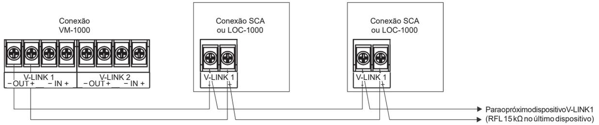
Figura 45. Exemplo de conexão do VM-1000 V-Link Classe B
