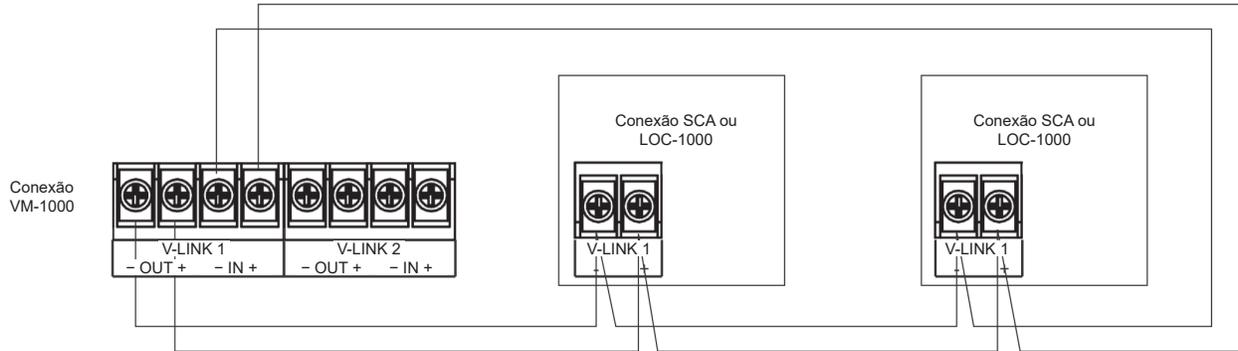
Figura 46. Exemplo de conexão do VM-1000 V-Link Classe A
