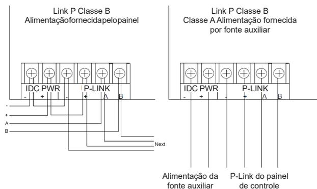
Figura 37. Conexão IDC-6 Classe B
