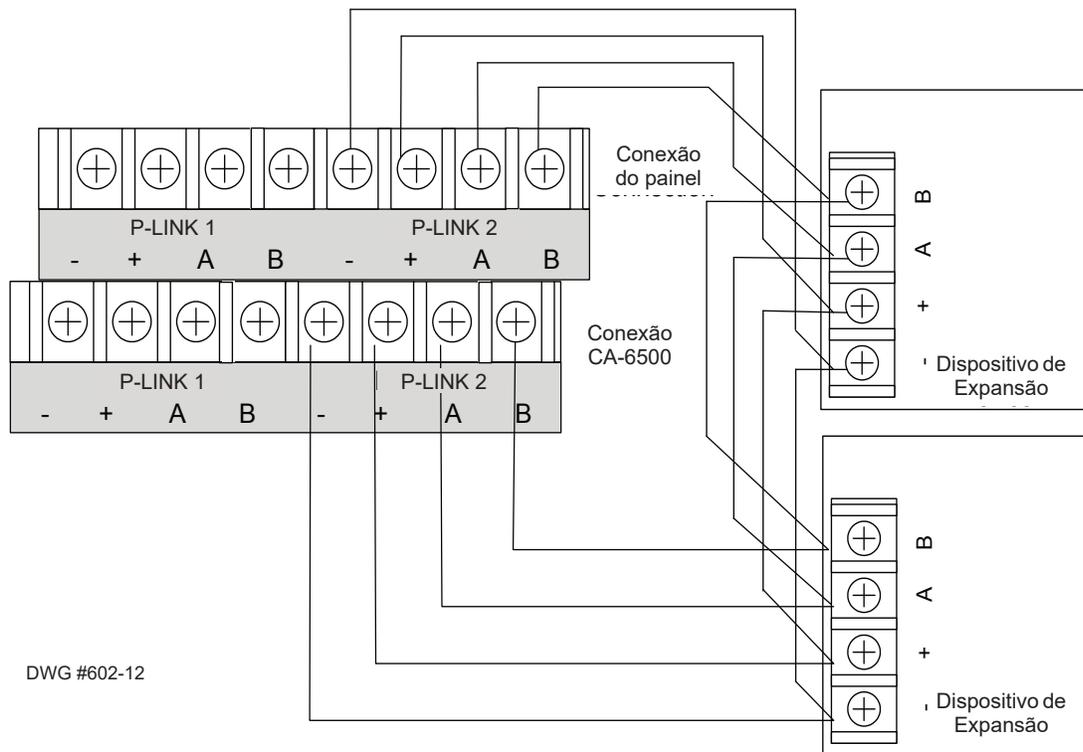
Figura 15. Exemplo de conexão P-Link Classe A Requer CA-6500
