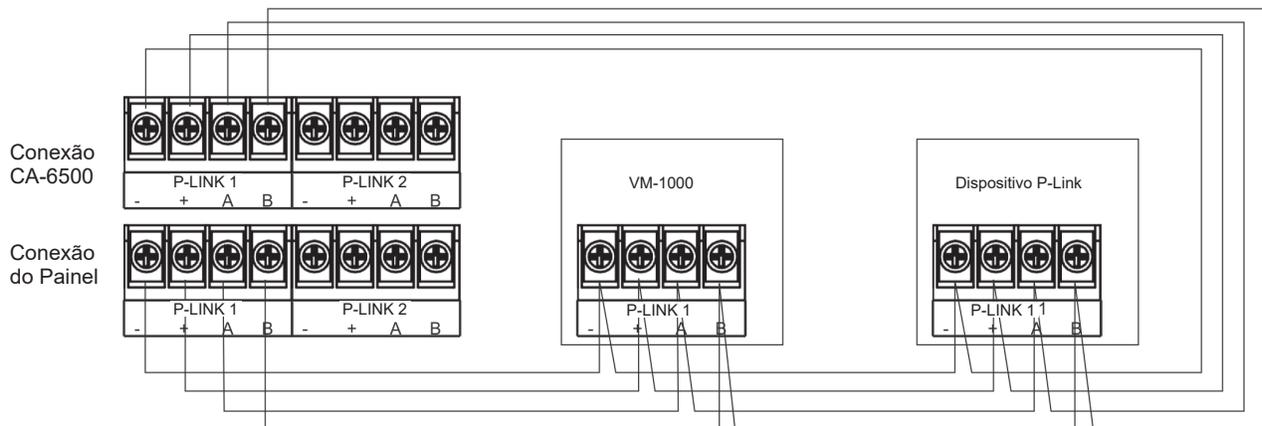
Figura 44. Exemplo de conexão VM-1000 P-Link Classe A
