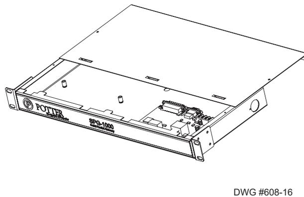
Figura 33. Placa de Portas Seriais/Paralelas SPG-1000 e Montagem em Rack
