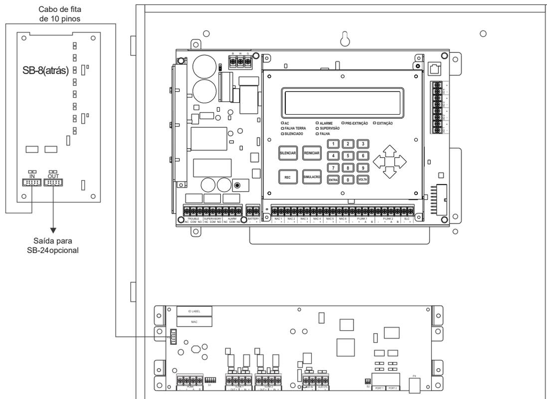
Figura 51. Conexão do SB-8
