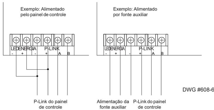
Figura 24. Exemplos de conexão de um Módulo LED-16/LED-16(F) para o Painel de Controle ou Fonte de Alimentação Auxiliar
